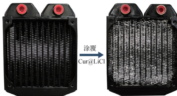
图 3 除湿换热器涂覆前后对比
